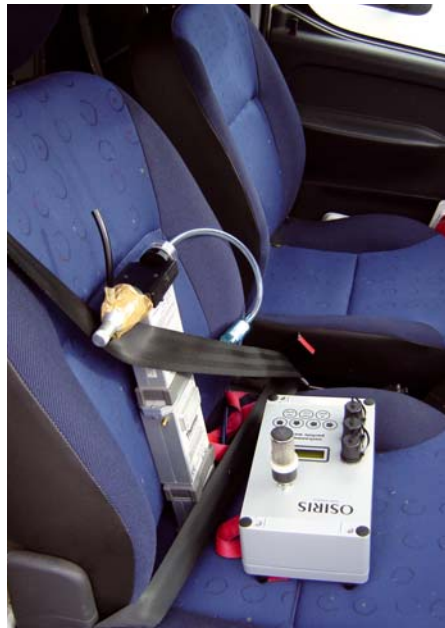
Mesures de particules dans l'habitacle du véhicule
