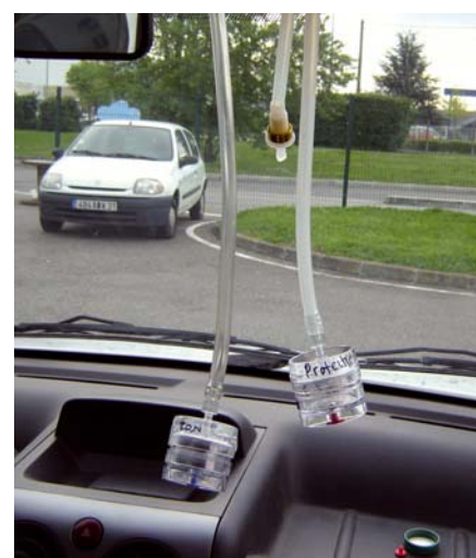
Dispositif de prélèvement d'air dans l'habitacle
