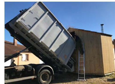
Benne vidangeuse ERE43 Vidange en 15min
